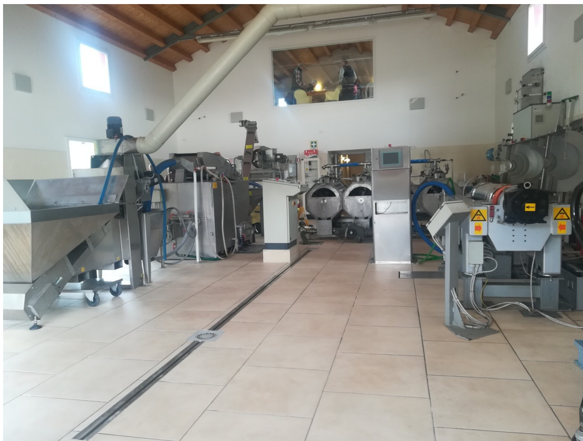
Tipico frantoio. Da sinistra zona travaso, lavaggio, frangitore, gramole, centrifuga, separatore.
